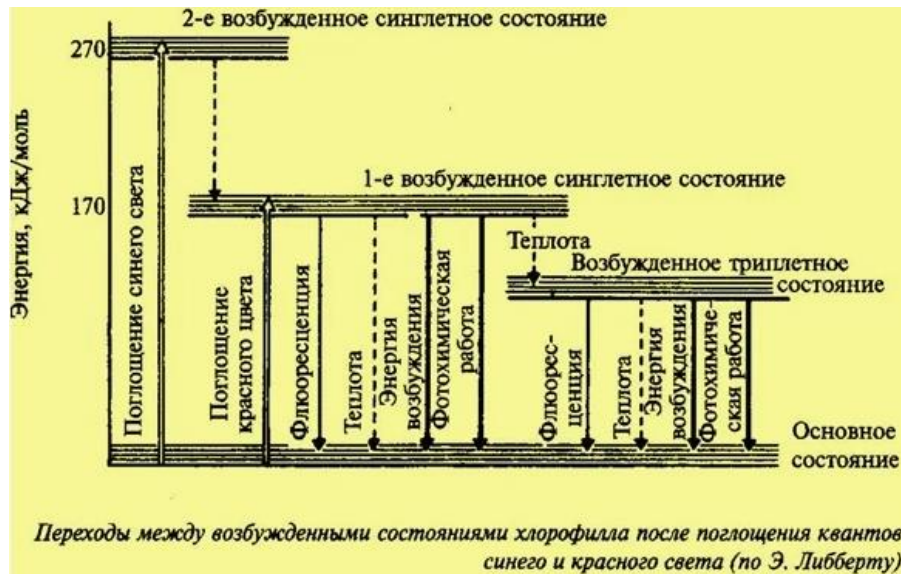
Рис. 8. Переходы между возбужденными состояниями хлорофилла после поглощения квантов света
