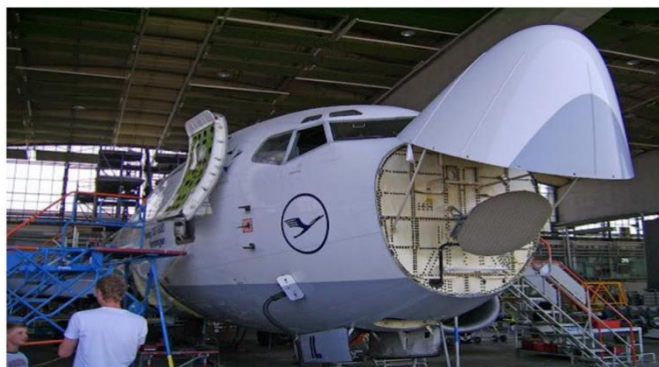
Рис. 5. Авиационный метеорологический РАДАР
