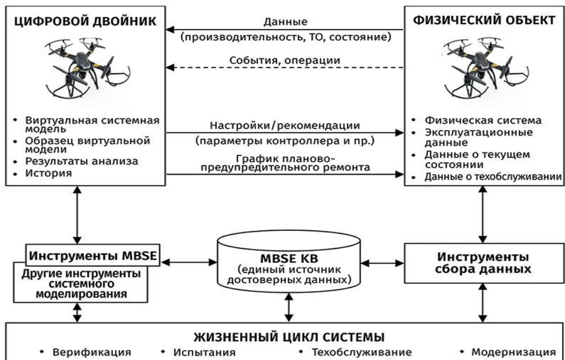
Рис. 3. Жизненный цикл цифрового двойника по данным uspet-vse.ru. [9]
