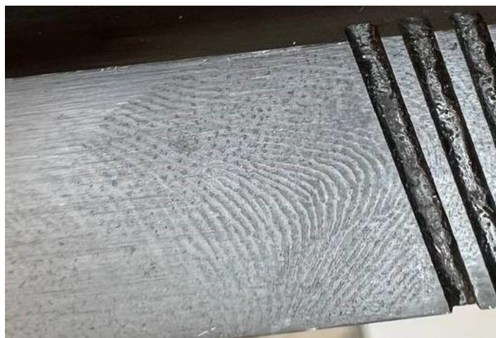
Рис. 5. Увеличенное изображение следа пальца руки, оставленного на затворе, после его выявления в цианакрилатной камере
