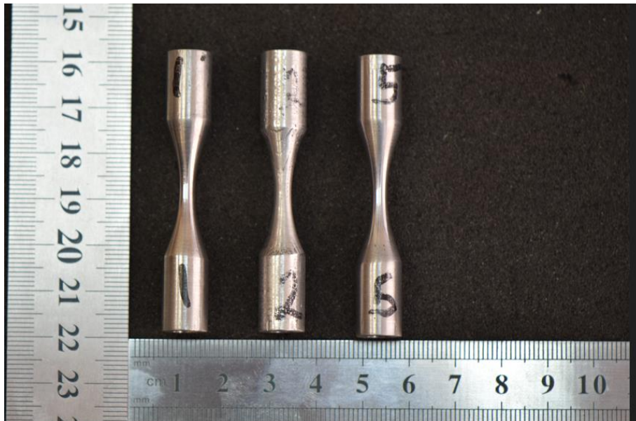
Рис. 8. Образцы для СВМУ исследований, полученные методом SLM
