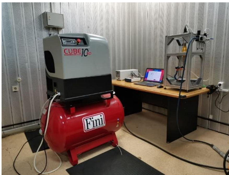
Рис. 7. Внешний вид пьезоэлектрической усталостной машины
