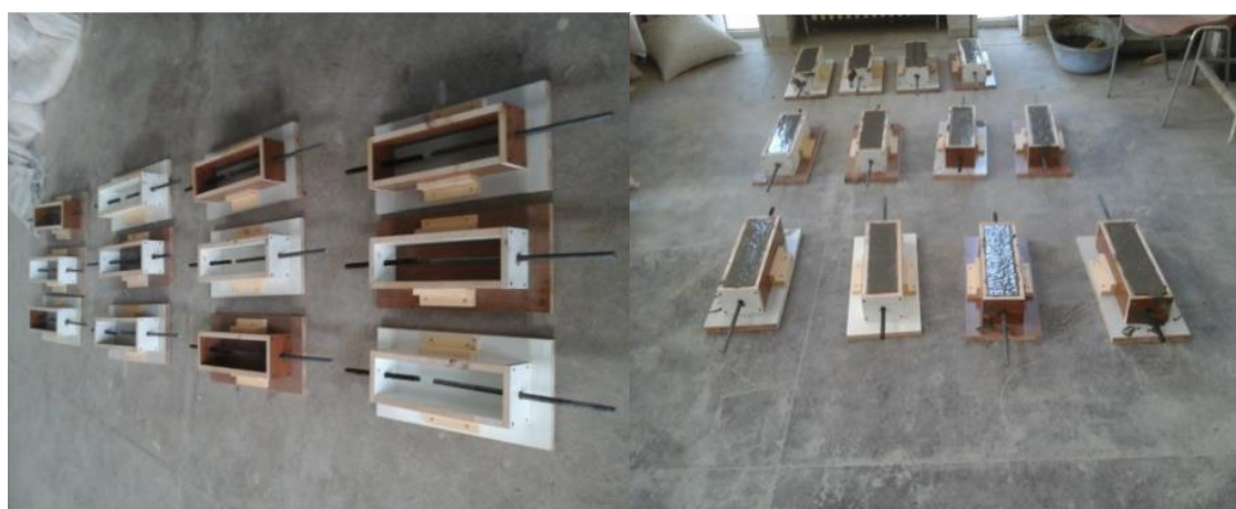
Рис. 2. Процедура литья и отверждения призм
