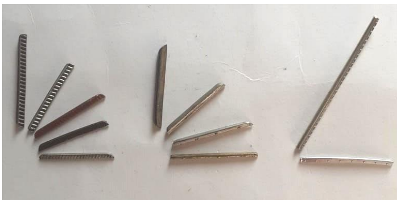
Рис. 5: слева-лад с ребристой нижней частью, в середине-лад с вытянутой тонкой пластинкой, справа-лад с чередованием на нижней части выпуклых элементов
