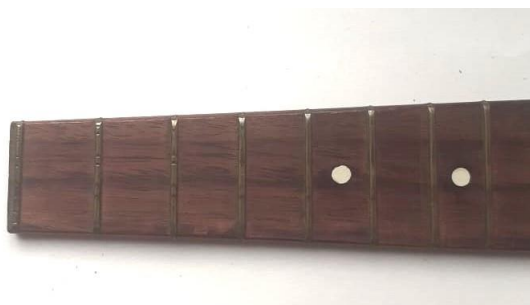
Рис. 9: установочный (нулевой) лад на накладке из красного дерева
