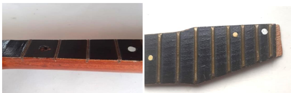
Рис. 7: лады установленные в накладке из бука, выкрашенного в черный цвет
