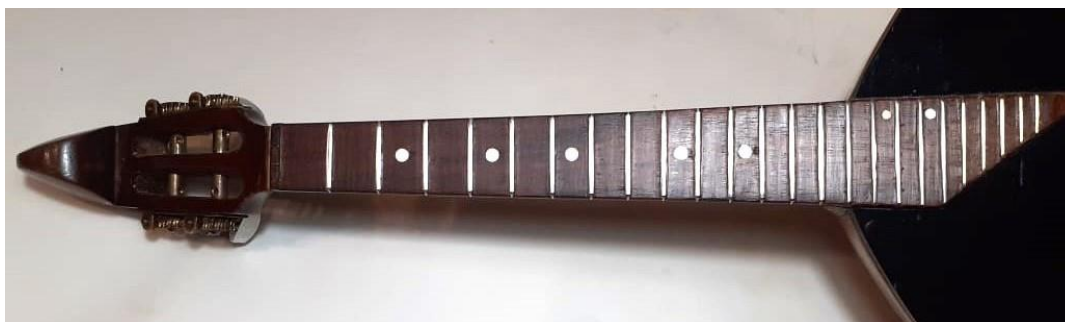
Рис. 11: авторский экспериментальный вариант установки ладов: с 1 по 14 лад – шириной 2мм, с 15 по 19 лад – шириной 1,5мм и с 20 по 24 лад – шириной 1мм
