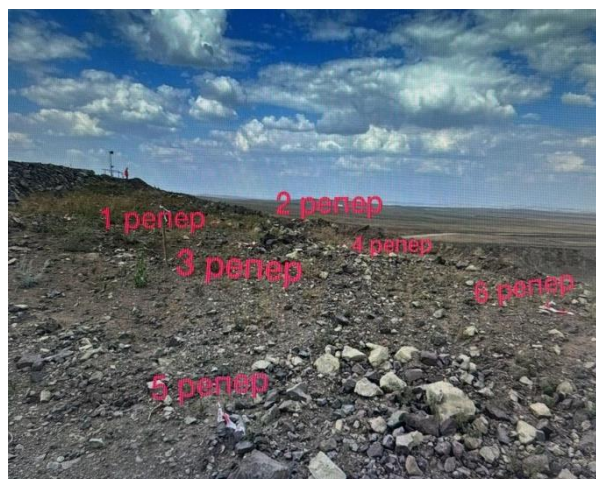
Рис. 1. Комплекс маркшейдерских наблюдений за деформациями борта карьера по геологическому профилю IX-IX
