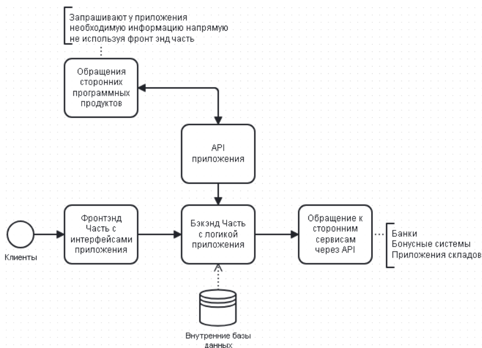
Рис. 1. Схема взаимоотношения модулей API
