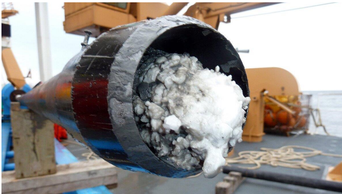
Рис. 1. Образование газовых гидратов в трубопроводе
