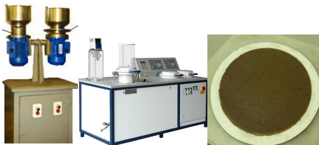
Рис. 1. Подготовка и формование многослойных образцов из небелённого вторичного волокна
