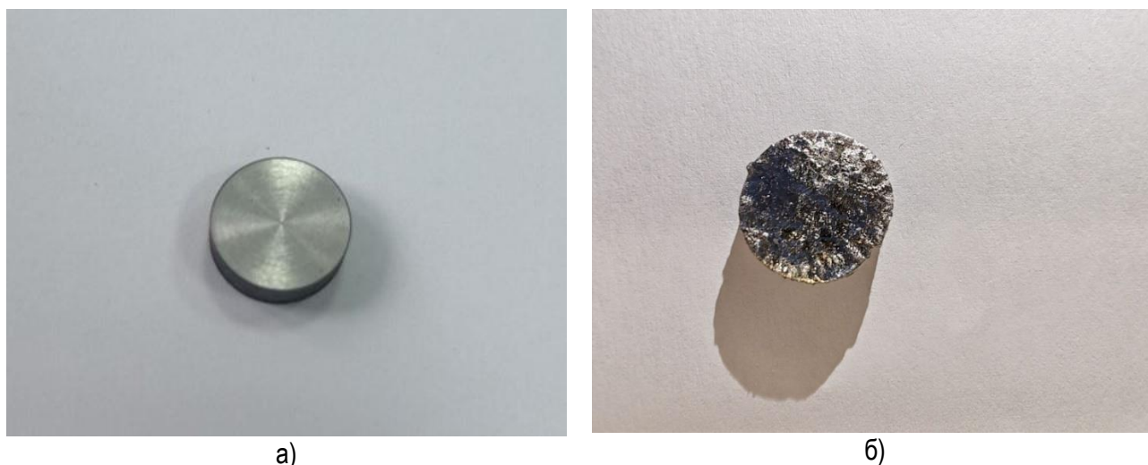
Рис. 1. Поверхность силумина до (а) и после (б) воздействия плазмы
