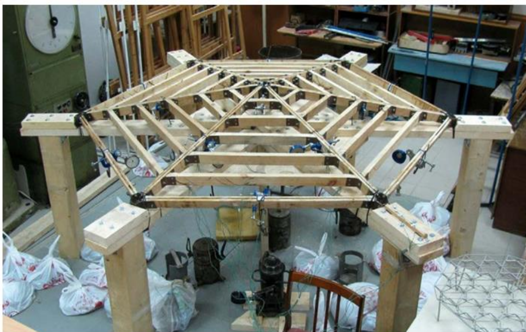
Рис. 6. Схема экспериментальной шестиугольной ячейки сетчатого купола из клеено-армированной древесины №2
