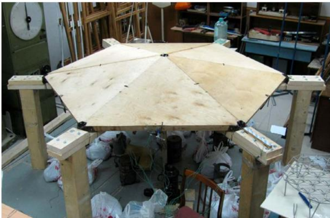
Рис. 7. Схема экспериментальной шестиугольной ячейки сетчатого купола из клеено-армированной древесины №3
