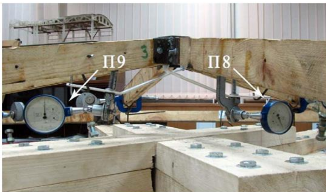
Рис. 9. Расположение прогибомеров П8, П9 в центральном узле сетчатого купола из клеено-армированной древесины
