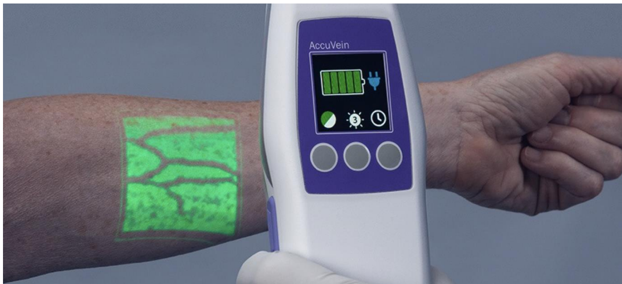
Рис. 5. Прибор AccuVein: использование AR для визуализации вен на коже пациента
