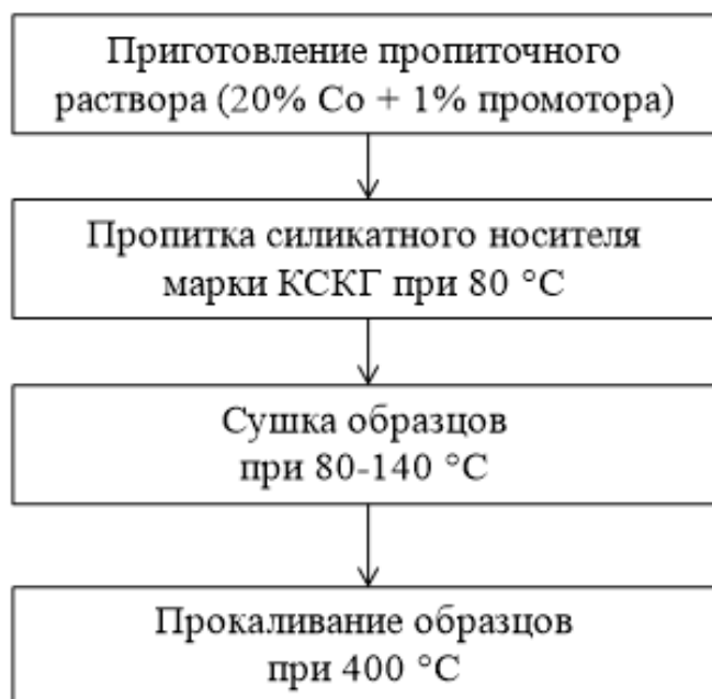
Рис. 1. Основные стадии приготовления кобальтовых систем
