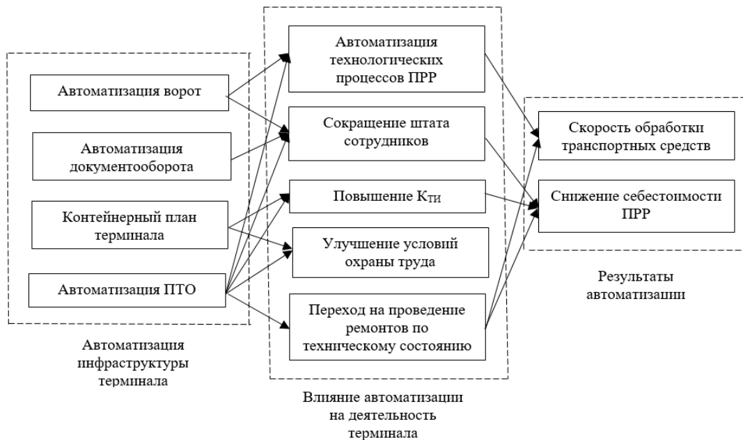
Рис. 3. Схема влияния автоматизации на работу КТ
