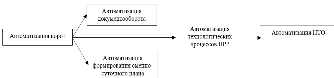
Рис. 1. Алгоритм автоматизации контейнерного терминала
