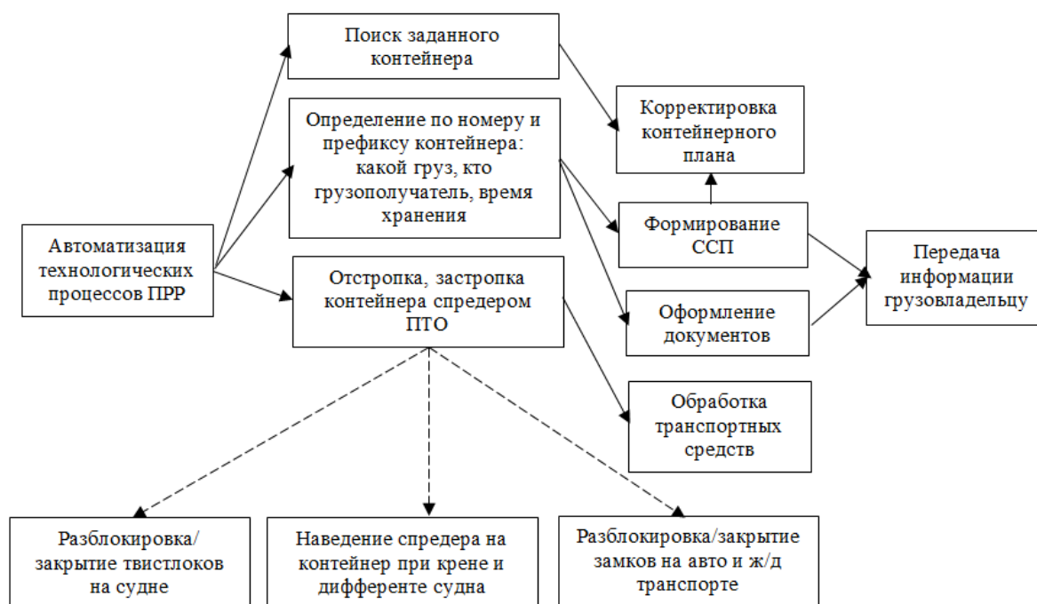
Рис. 4. Технологические процессы КТ, выполняемые в автоматизированном и ручном режимах работы:
