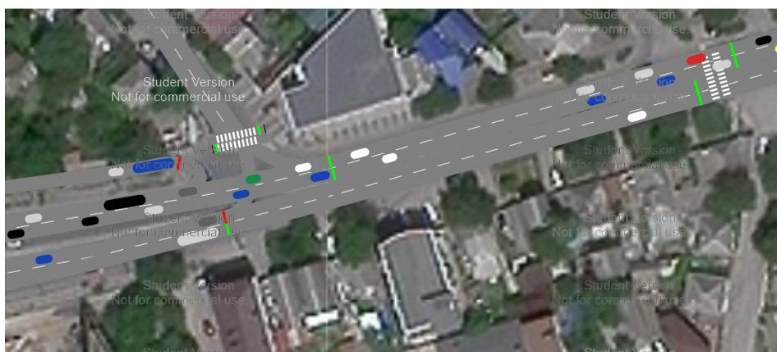
Рис. 8. Проектируемая модель движения транспортных средств с внедрением светофорного объекта
