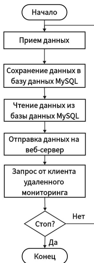
Рис. 5. Блок-схема программы сервера
