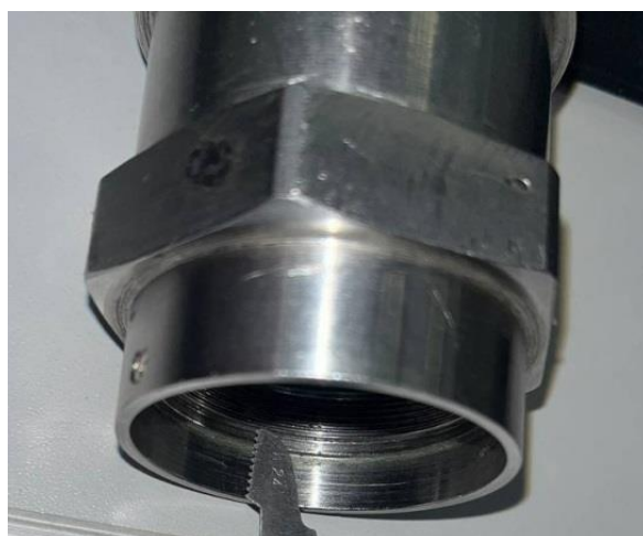
Рис. 4. Измерение шага внутренней резьбы резьбомером
