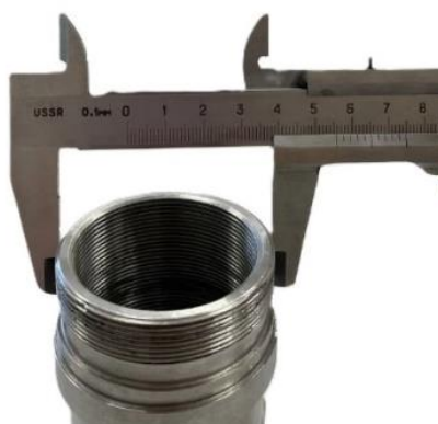
Рис. 3. Измерение диаметра резьбы муфты штангенциркулем
