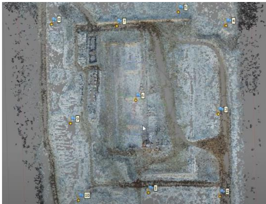
Рис. 3. Опорные точки (реперы) на участке работы дрона
