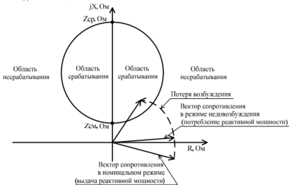
Рис. 5. Характеристика защиты от асинхронного режима
