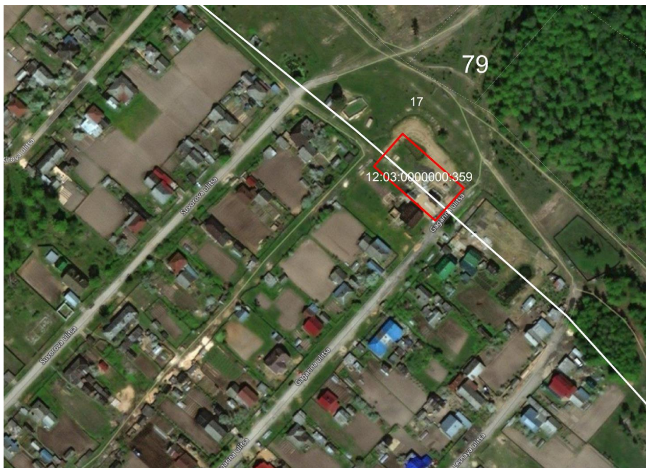
Рис. 2. Пересечения (наложения) земельных участков в планируемых границах населенного пункта Килемары (космический снимок)
