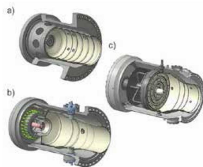
Рис. 1. Различные системы сжигания: а) диффузионное пламя, б) дополнительная горелка, с) горелка микро-микс
