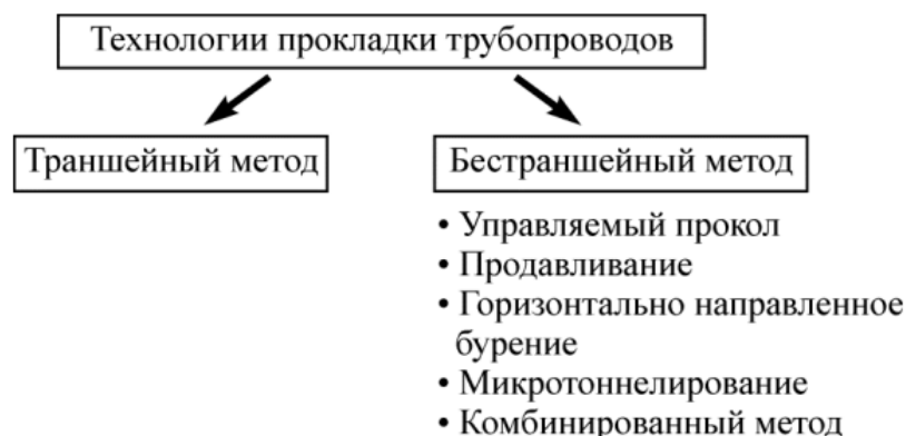
Рис. 1. Классификация методов прокладки трубопроводов
