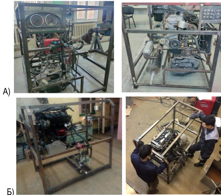
Рис. 3. Лабораторный стенд ДВС «Mazda Demio ZJ 1,3 L» и «Toyota 1NZ-FE»
