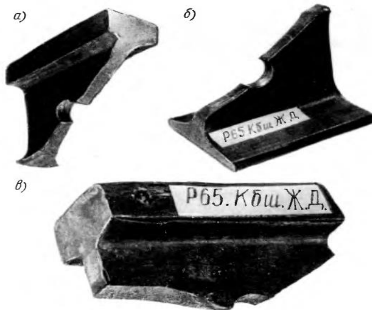
Рис. 6. Характерные изломы рельсов в зонах стыков
