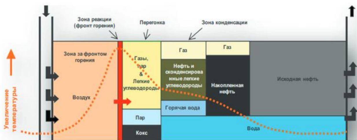
Рис. 3. Схематическое изображение процесса внутрипластового горения
