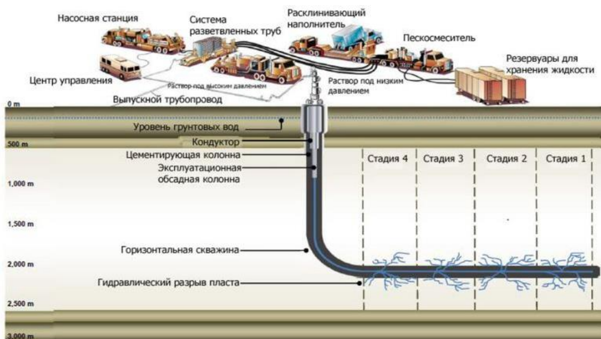
Рис. 1. Схема гидроразрыва пласта в горизонтальной скважине
