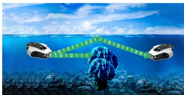
Рис. 6.1. Процесс передачи данных в условиях NLOS с использованием эффекта внутреннего отражения от границы раздела воздух-вода
