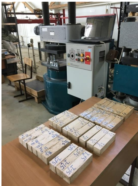
Рис. 1. Стандартные образцы представляют собой призмы с квадратным поперечным сечением 160 x 40 x 40 мм
