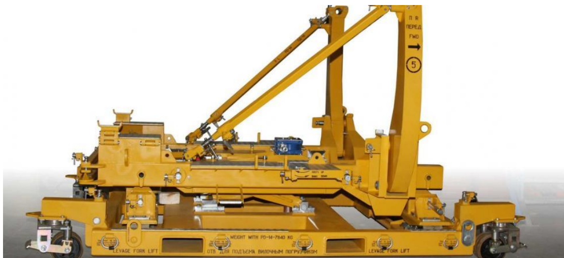
Рис. 1. Транспортировочно-монтажное устройство для ПД-14
