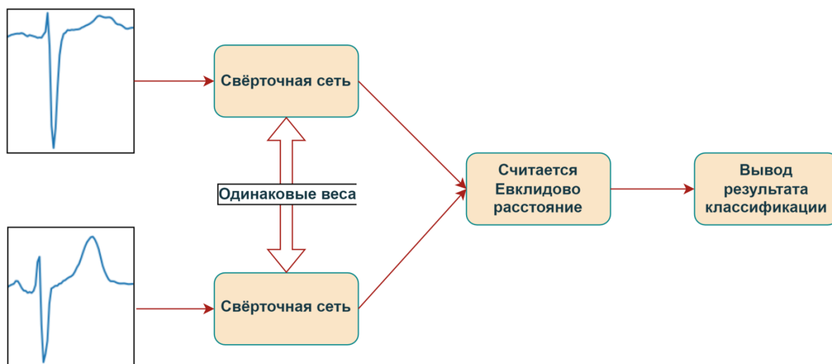
Рис. 3. Обобщенная архитектура сиамской нейронной сети
