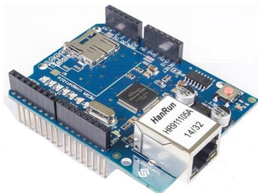
Рис. 2. Внешний вид платы *Arduino Ethernet Shield W5100*
