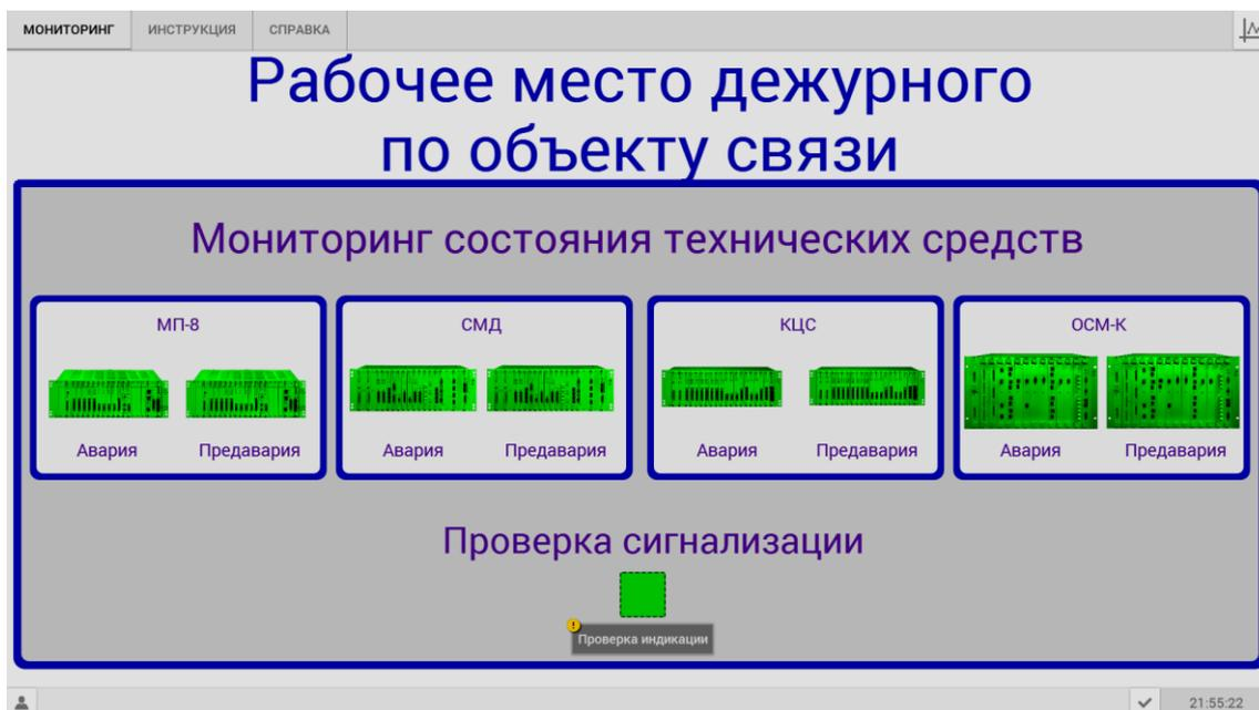
Рис. 5. Снимок экрана вкладки «Мониторинг» ПО *Simple-Scada* на экране ПК рабочего места дежурного по объекту связи
