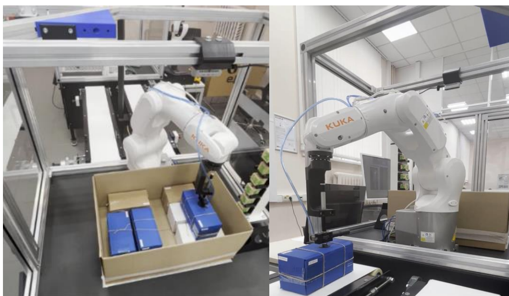
Рис. 1. Макет роботизированного комплекса для исследования процесса выгрузки посылок из контейнера
