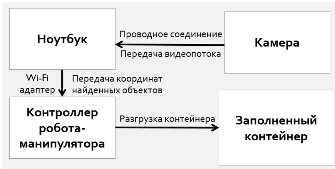
Рис. 2. Последовательность работы макета роботизированного комплекса выгрузки посылок из контейнера
