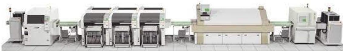
Рис. 2. Пример линии поверхностного монтажа
