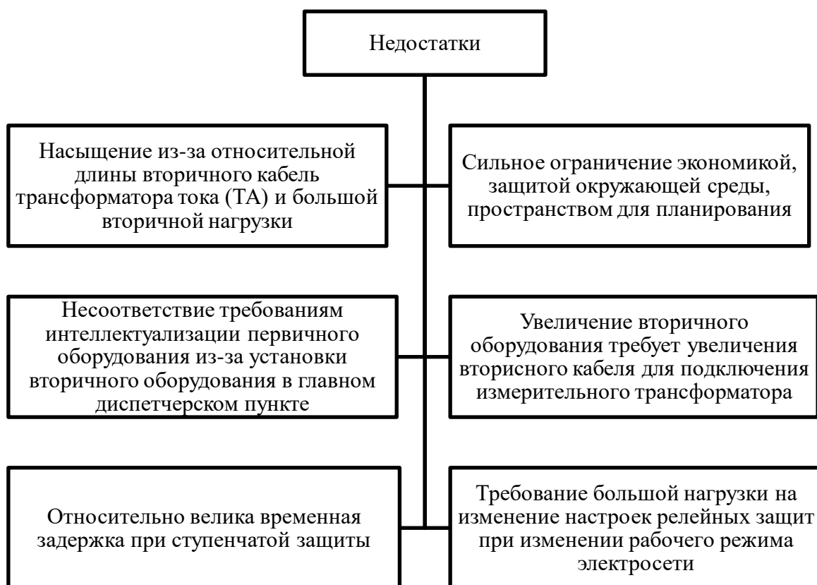
Рис. 1. Некоторые недостатки релейной защиты традиционных подстанций
