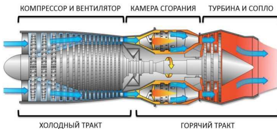
Рис. 1. Конструкция классического турбореактивного двигателя
