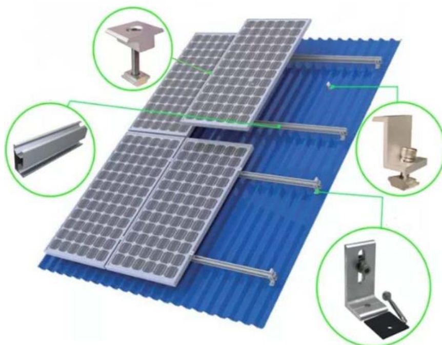
Рис. 1. Монтаж фотоэлектрических модулей на опорную раму
