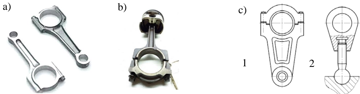
Рис. 1. Шатуны: с разной формой стержня (а), автомобильный (б), штамповочных машин (с) (1 – шатун с нерегулируемой длиной; 2 – шатун с регулируемой длиной)
