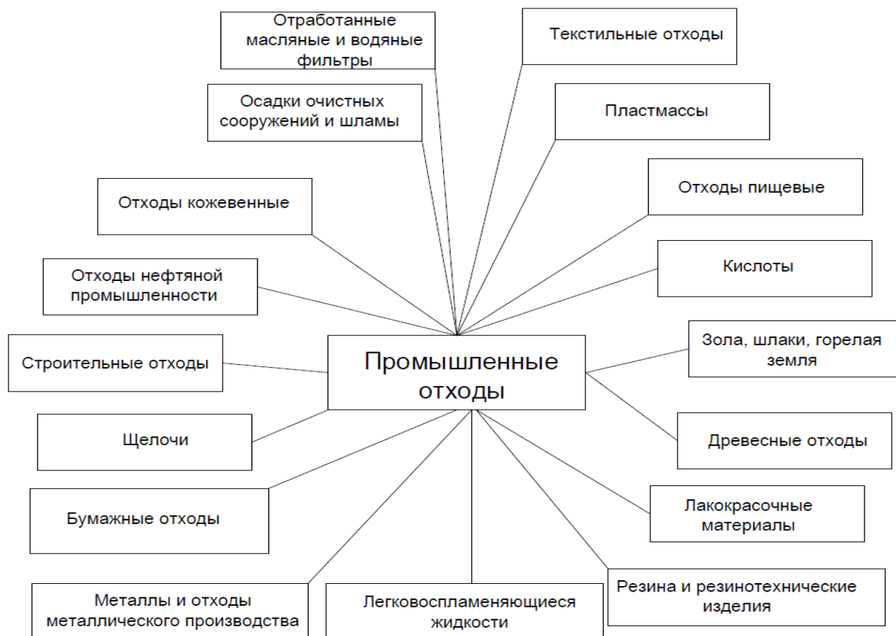
Рис. 3. Источники возникновения твердых отходов материальном производстве
