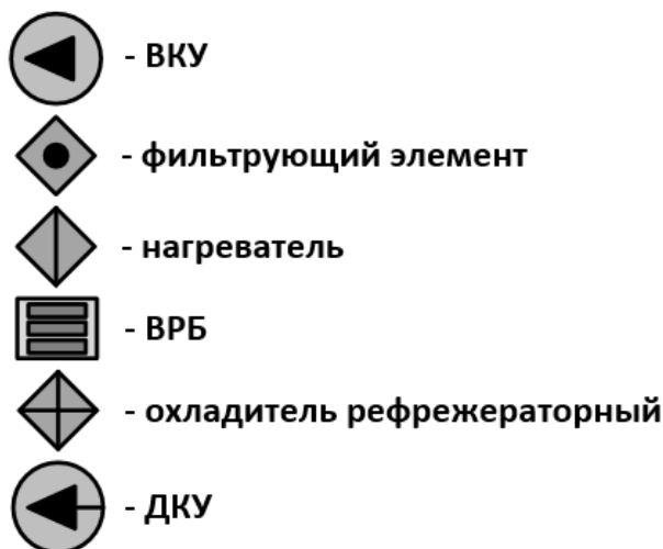
Рис. 3. Обозначения устройств технологической схемы МАУК
