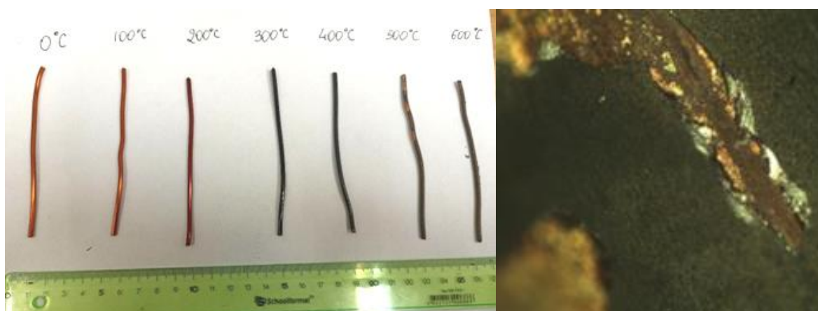
Рис. 3. Изменение поверхности после отжига: а – всех образцов после отжига при различной температуре; б – образца после отжига при температуре 600 °С
