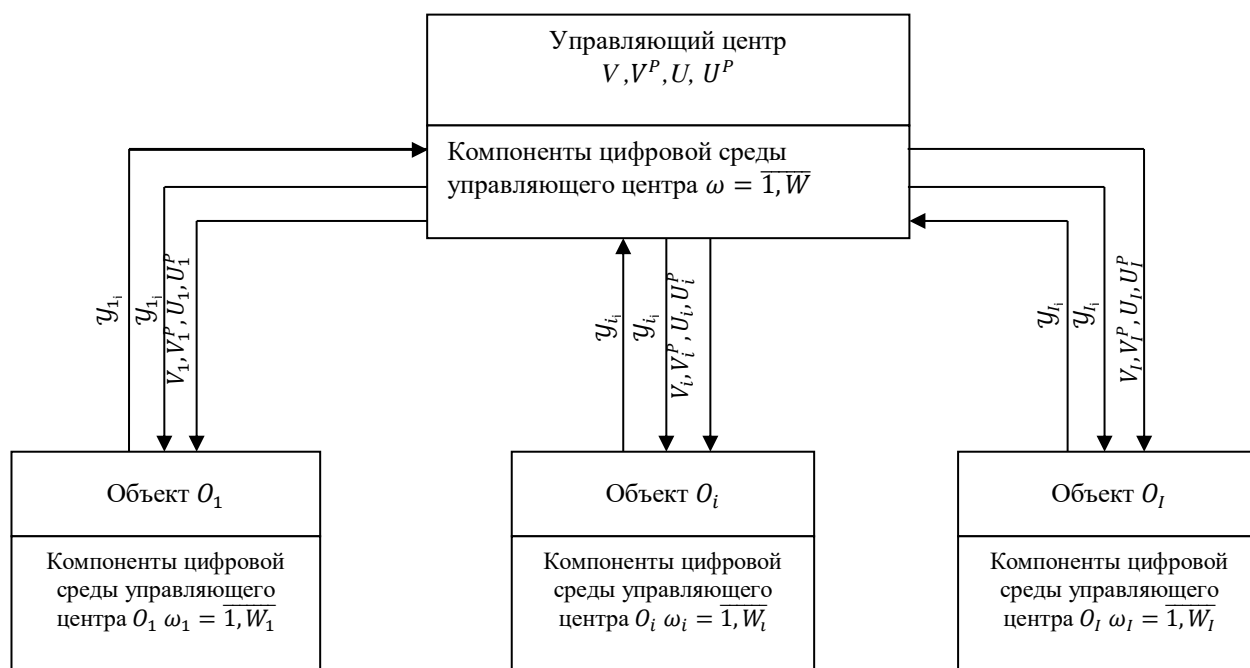
Рис. 1. Структурная схема взаимодействия управляющего центра и объектов в цифровой многообъектной организационной схеме
