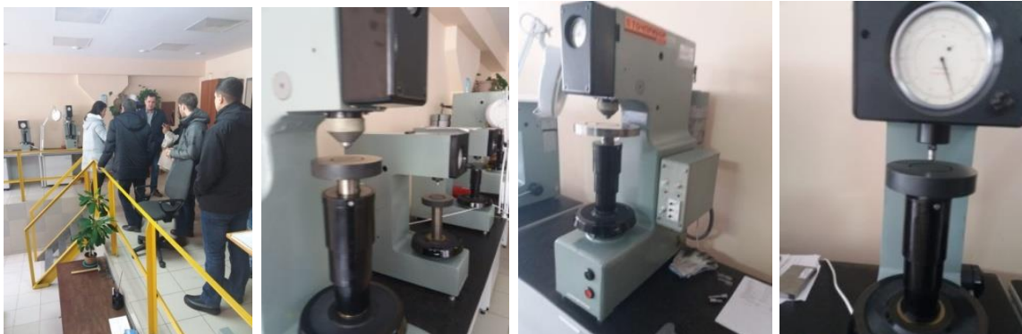
Рис. 2. Приборы для измерения твердости материалов элементов ж/д транспорта Испытательного центра ТОО «КазЦСЖТ»
