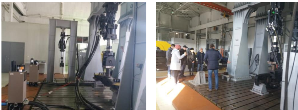
Рис. 4. Практическое занятие на универсальном испытательном стенде СИ-02.00.000 для испытаний корпусов автосцепок на растяжение
