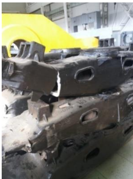
Рис. 3. Вид разрушений боковой балки рамы тележки после проведения испытательных нагрузки
