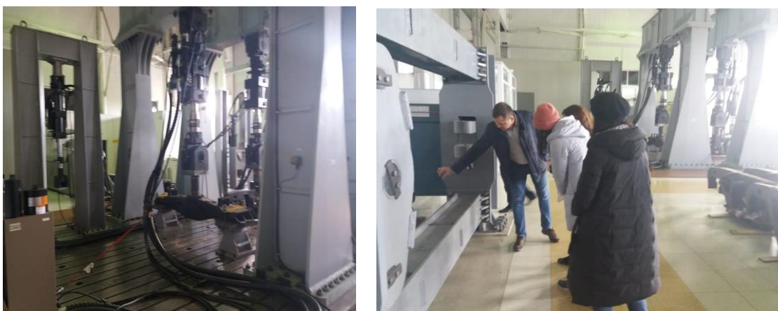
Рис.5. Практическое занятие на универсальном испытательном стенде СИ-02.00.000 для проведения статических и усталостных испытаний деталей и узлов железнодорожных вагонов
