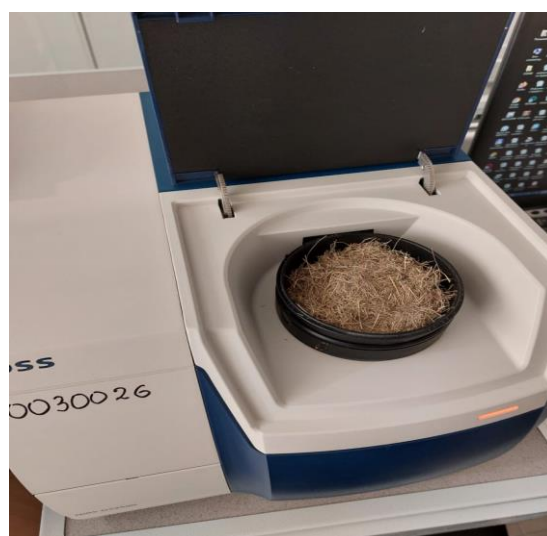
Рис. 1. Определение химического состава кормов на приборе FOSS NIRS DS2500
