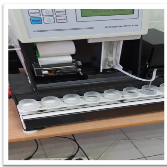
Рис. 2. Определение химического состава на приборе Лактан 1-4М исполнение 700
