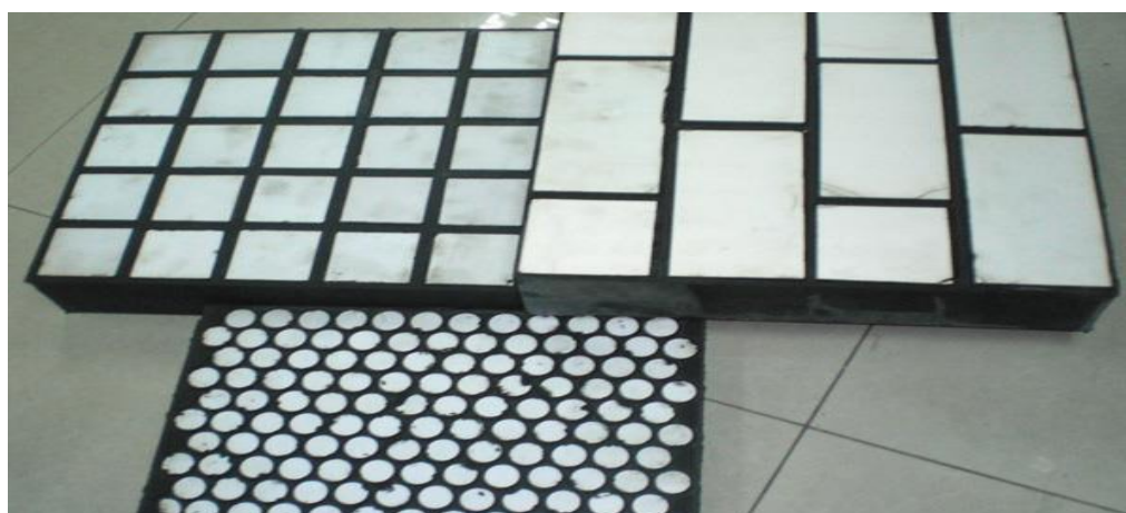
Рис. 2. Резино-керамическая футеровка, различные виды
