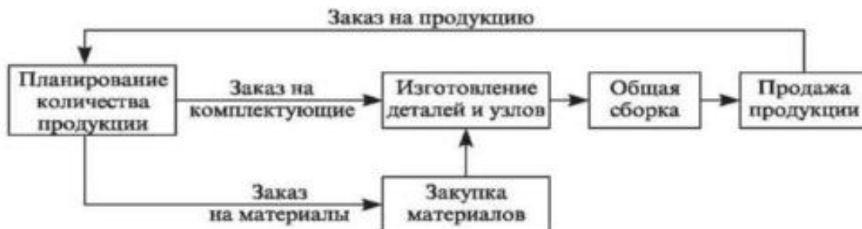
Рис. 1. Традиционная схема организации производства
