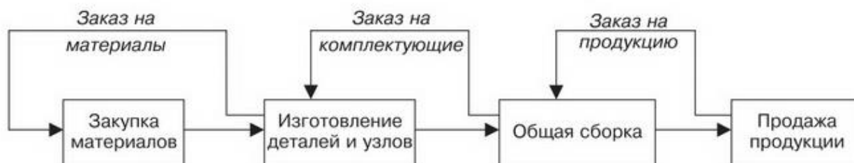
Рис. 2. Схема производства по методу «точно в срок»
