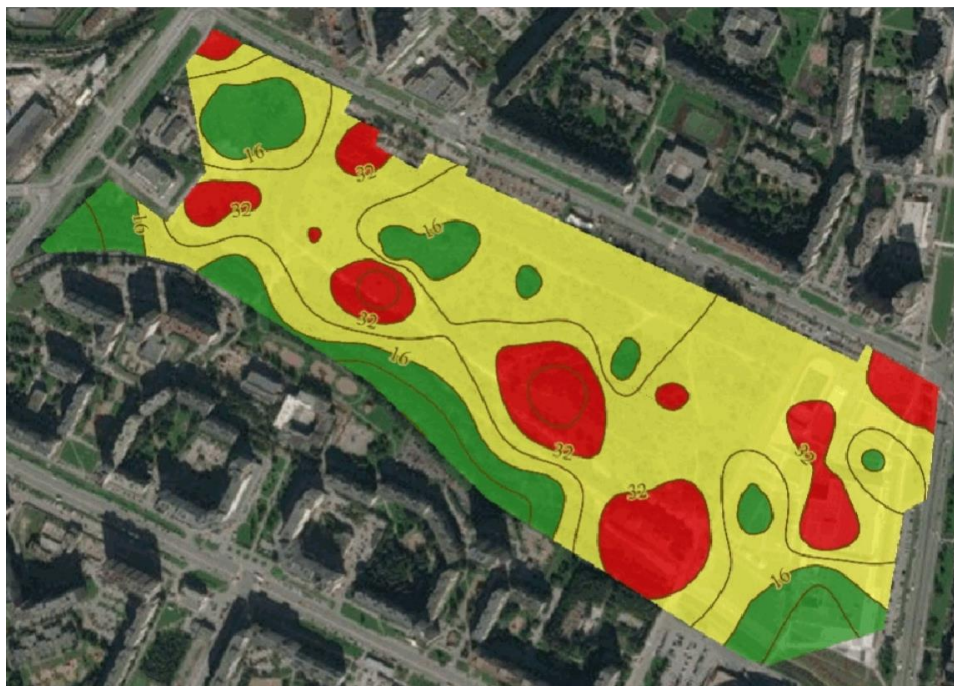
Рис. 2. Схема загрязнения верхних слоев почвы на территории Яблоньской свалки (по показателю загрязнения почвы Z_c )
