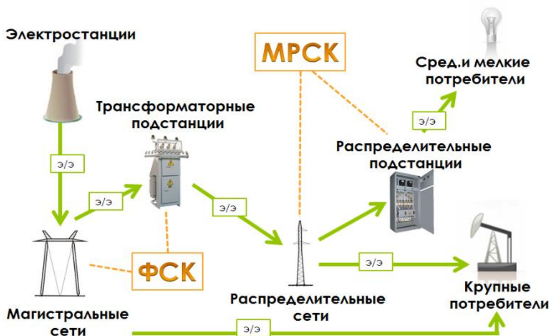
Рис. 2. Модель распределения электроэнергии по сети
