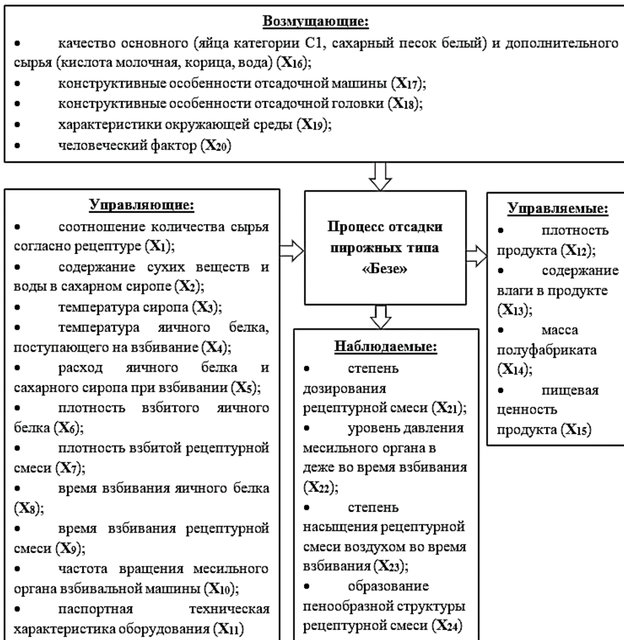
Рис. 1. Параметрическая схема процесса отсадки пирожных типа «Безе»
