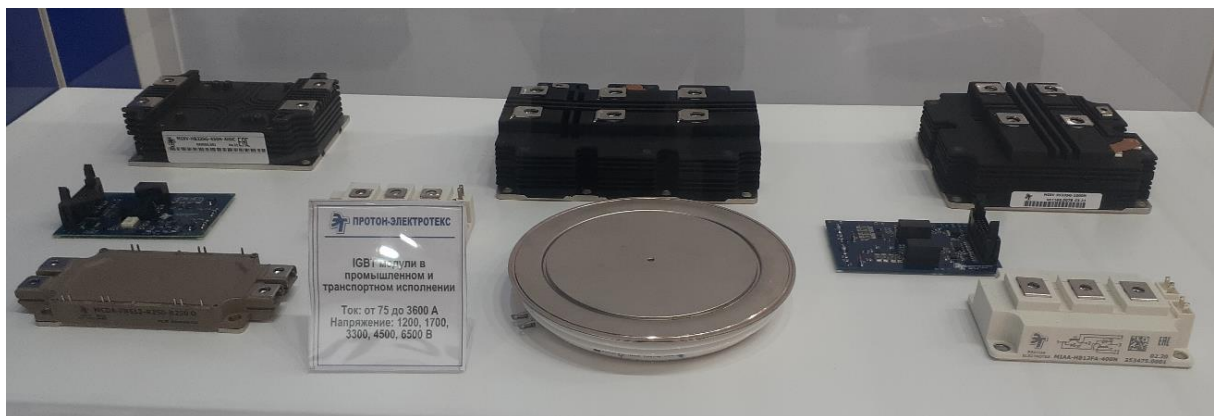
Рис. 1. Силовые полупроводниковые IGBT компании «Протон-Электротекс» для трехфазного трехуровневого инвертора напряжения
