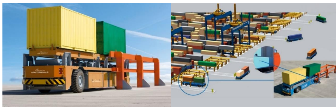
Рис. 2. Самоподъемное автоматизированное управляемое транспортное средство Lift AGV (Lift Automated Guided Vehicles)
