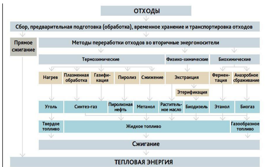
Рис. 1. Методы сжигания отходов для создания теплоэнергии
