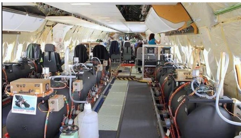
Рис. 5. Баки специального керосина внутри фюзеляжа самолета. [23]
